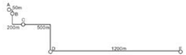
Abb. 4 - Beispiel für einen Startpunkt für eine Einblasstrecke
