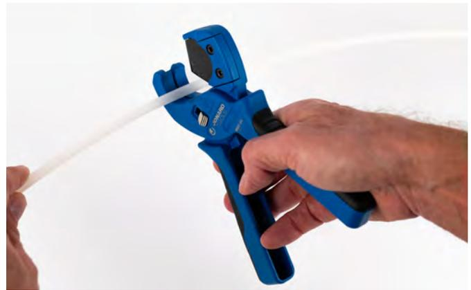
Bei den Einzelrohren 3mm und 5mm muss vor dem Verbinden der Mantel entfernt werden. Hierzu diesen ca. 2cm vom Rohrende entfernt mit einem Jokari Messer o.Ä. umlaufend anritzen und abziehen. Anschließend die beiden Rohrenden vollständig und bis zum mittigen Anschlag in den Verbinder einschieben. Es darf keine Lücke zwischen Anschlag und Rohrende entstehen, welche das Kabeleinblasen behindern könnte.
