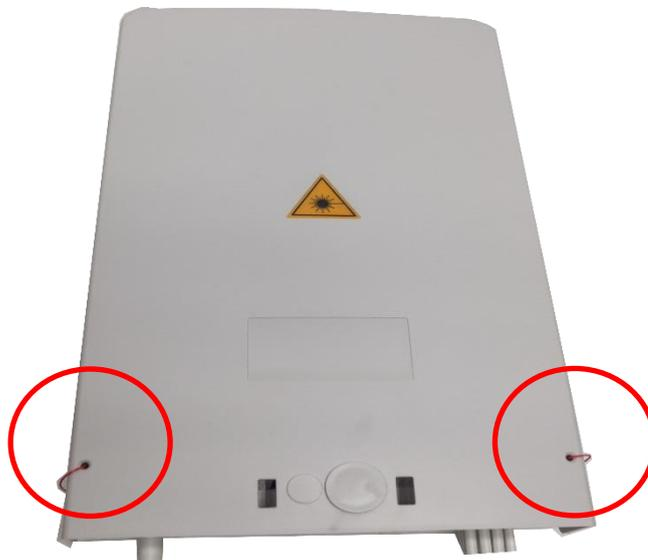
Gehäusedeckel kann mit dem Gehäuse im geschlossenen Zustand beidseitig versiegelt werden
