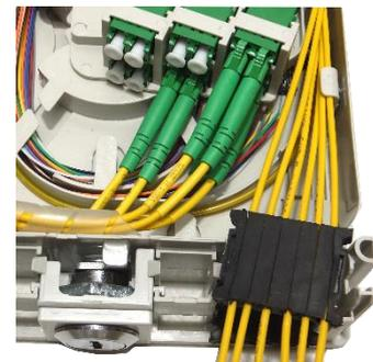
Beim Einbau der Anschlusskabel Dichtungsgummi herausnehmen, Kabel in den geöffneten Kanal einlegen und Dichtungsgummi mit Abschlussoberteil einbauen.
