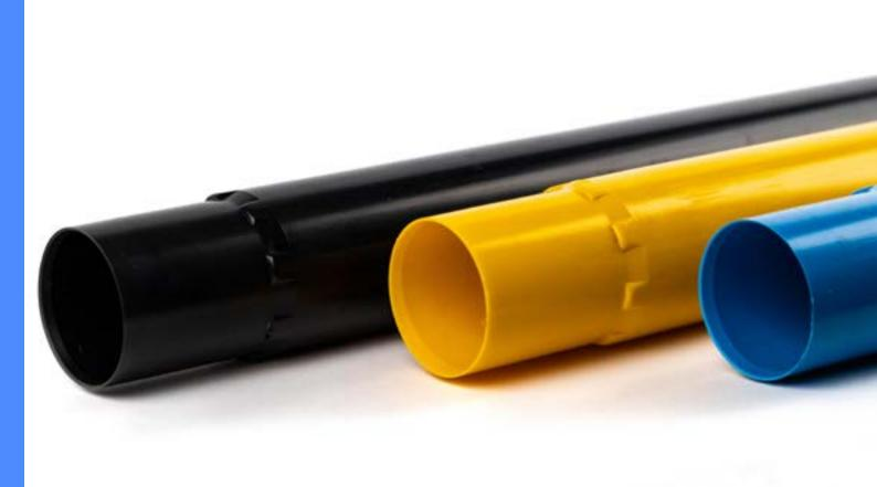
HexaJet Schutzrohre aus PVC-U bieten Ihren Gas-, Trinkwasser-, Telekommunikations- und Stromleitungen höchste Sicherheit gegen mechanische Beschädigungen beim Verlegen. Die HexaJet Schutzrohre werden als Vortriebsrohre im Berstlining- und Bodenverdrängungsverfahren kostengünstig und einfach verlegt. Die speziell angeformte, innenliegende Muffe gewährleistet eine glatte Außenfläche der Leitung zur Minimierung der Mantelreibung.
