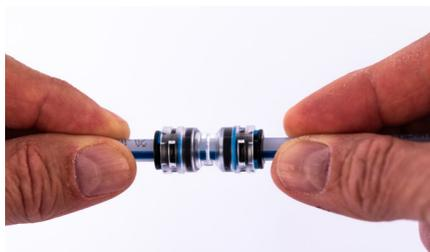
Um das Mikrorohr vom Verbinder zu trennen, stellen Sie sicher, dass der Druck im System vollständig abgebaut wurde, bevor Sie mit der Durchführung beginnen. Entfernen Sie zuerst die Verriegelungsklemme. Drücken Sie dann den Spannring in Richtung des Verbinders und ziehen Sie das Mikrorohr heraus.
