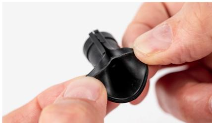
3. Dichtung um das Mikrorohr und das Glasfaserkabel legen. Die kleinere Öffnung des Gummikörpers befindet sich auf der Seite des Glasfaserkabels.
